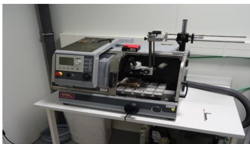
Equipements de découpe à disque et à fil (horizontale et verticale) à liant résine (poudre de diamant)
