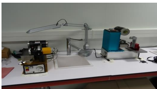
Equipements de découpe à disque et à fil (horizontale et verticale) à liant résine (poudre de diamant)
