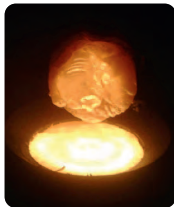
Refusion en drip melting d'un acier maraging au four à bombardement électronique Drip melting of a maraging steel in the electron beam melting furnace
