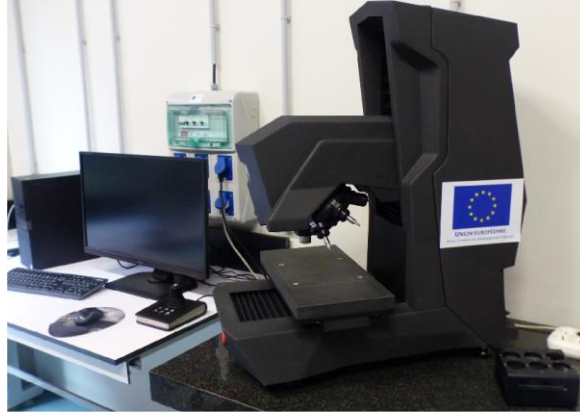
A gauche : opération Pilotage de chauffe - A droite : opération Appareil de microdureté
